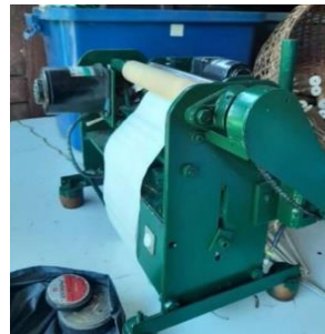
เครื่องฝานต้นโสนเป็นแนวคิดในการพัฒนาต่อยอดเพื่อเพิ่มประสิทธิภาพในการผลิตดอกไม้จากต้นโสนทางไก่อ
